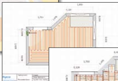
Монтажная схема системы T2Red
