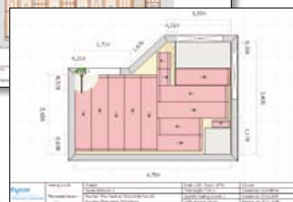
Монтажная схема системы T2QuickNet
